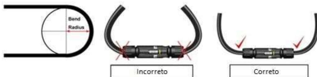
Figura 4: O roteamento correto e o raio de curvatura mínimo dos cabos.
